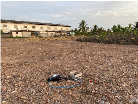
รูปที่ 2 วิธีการทดสอบการหาชั้นดินด้วยวิธี Microtremor
